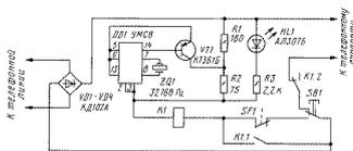
Предлагаемое устройство выполняет функцию удержания телефонной линии ("HOLD"), что позволяет во время разговора положить трубку на рычаг и перейти к параллельному телефонному аппарату.
